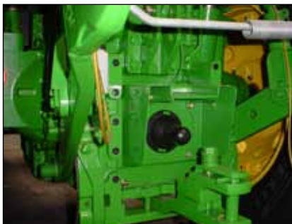
Embout de prise de force et capuchon de protection
