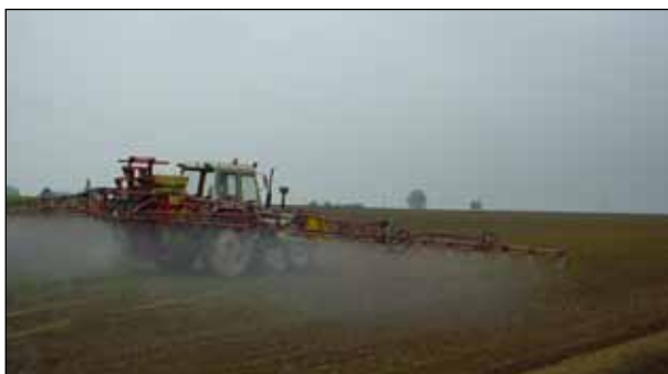
Brouillard de bouillie produit par un pulvérisateur porté
